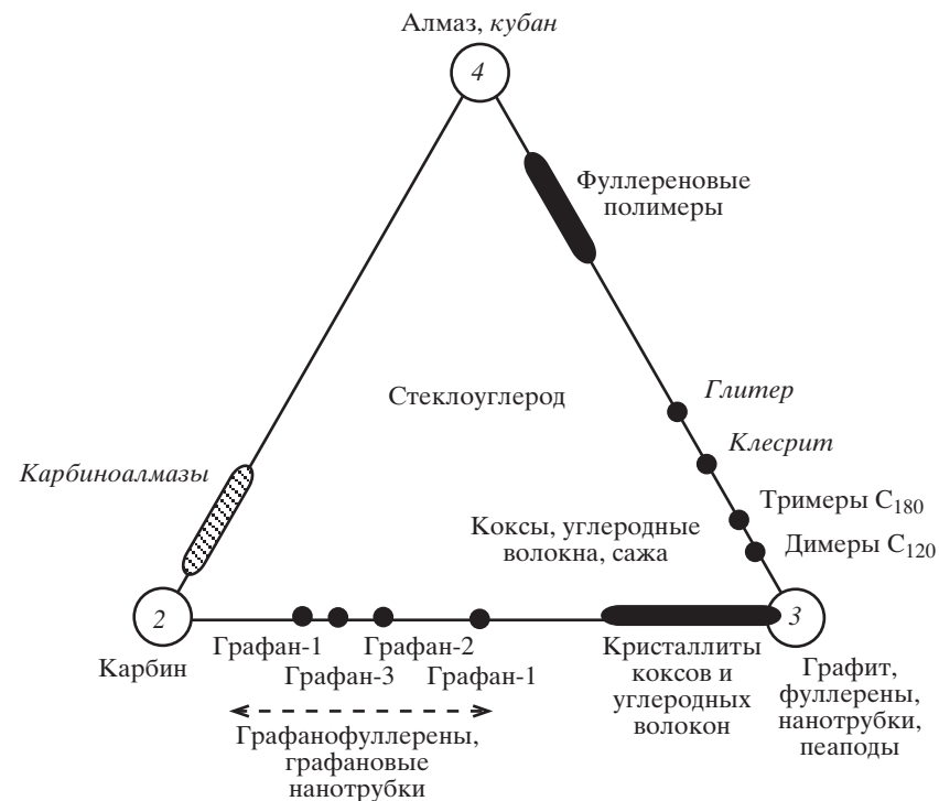
Рис. 1.3. Схема структурной классификации [26] углеродных материалов по количеству соседних атомов в первой координационной сфере или по соотношению атомов образующих в материале 2, 3 или 4 ковалентных связи ( курсив – гипотетические структуры)
